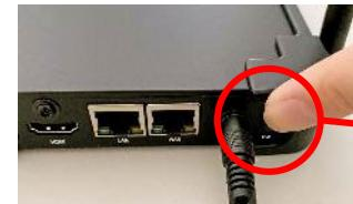
背面にある電源スイッチを押してOFFにします
